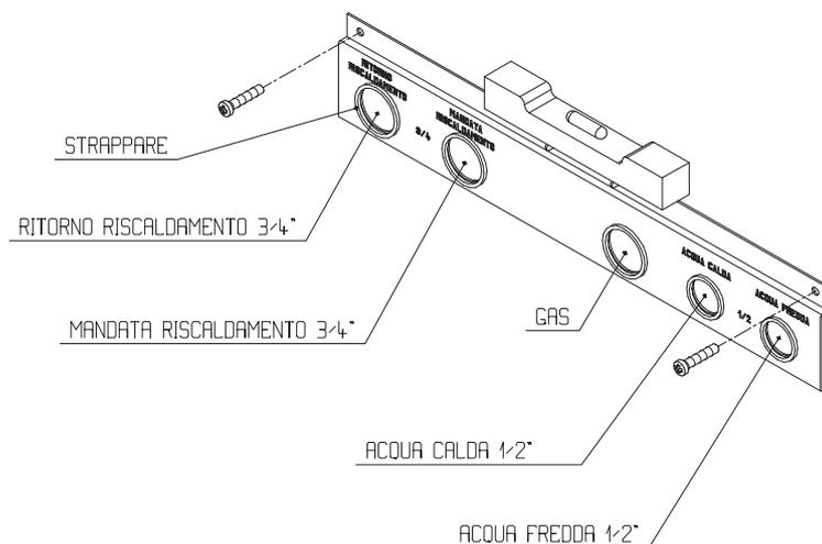
Per il montaggio della piastra di supporto della caldaia, usare come riferimento la fascia in plastica a questa collegata (vedi figura).
